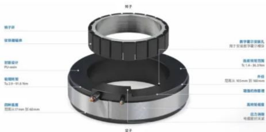
그림 9. 프레임리스 토크 모터 구조
