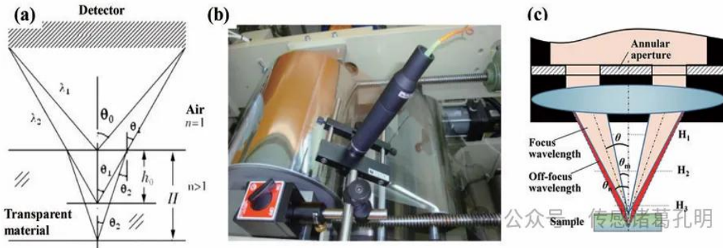
그림 6. 투명 박막 두께 측정 원리 (a) (b) 이중반사 피크차이법 (c) 고정입사각 간섭계 역산법
