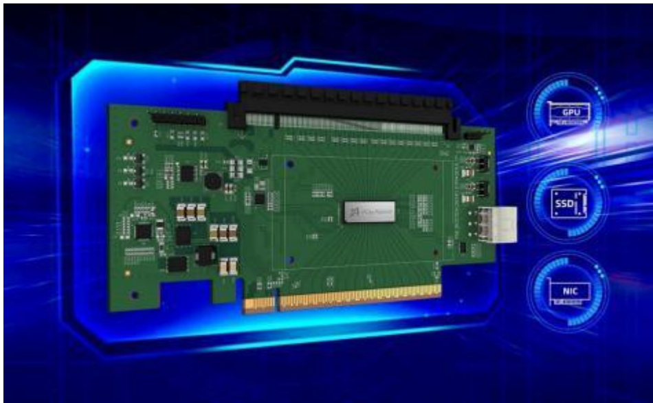
사진 1) PCIe 5.0/CXL 2.0 Retimer 칩 개략도
