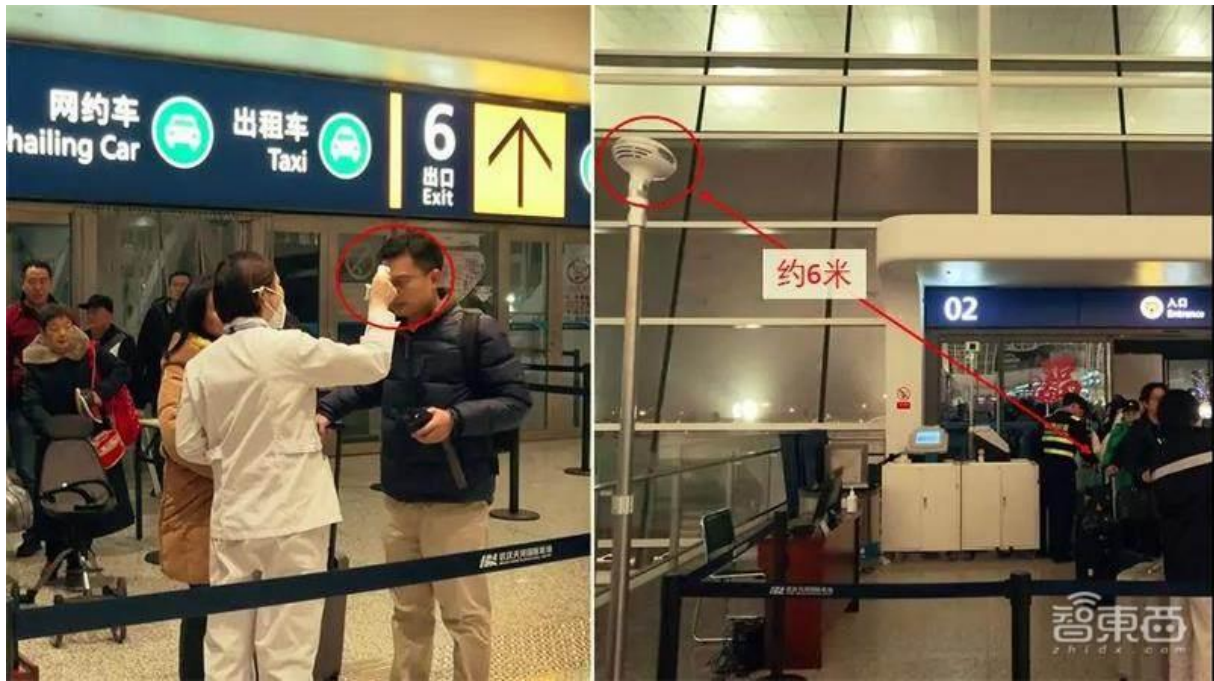
사진 4) 출처: 지동서智东西, 기존의 이마 체온측정건, 온도계와 비교하여 적외선 체온 감지기는 원거리에서 체온을 측정할 수 있다.
