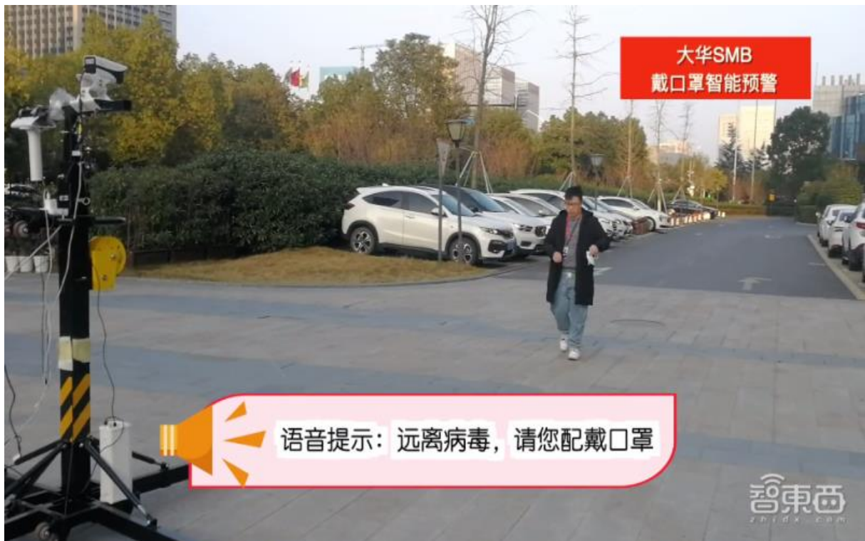
사진 7) 출처: 지동서智东西. 마스크를 안 찬 사람을 식별하는 감시카메라
