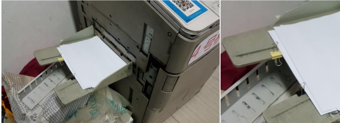
그림 1) 프린터의 종이 나오는 부분에 클립으로 종이가 떨어지는 것을 방지하였다
